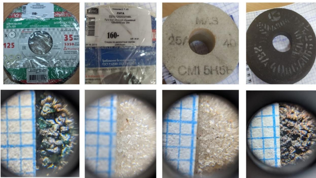
Рис. 34. Полученные смартфоном фотографии абразивных инструментов и их структур
